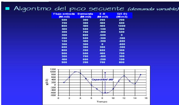
Figura 3. 43 Esquema de un algoritmo del pico secante
