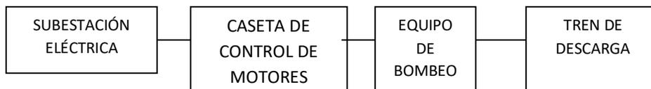
Un arreglo típico de una planta de bombeo en un cárcamo sería:
